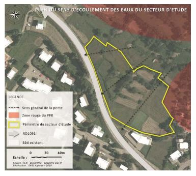
La topographie est peu accidentée au regard de la commune avec une pente Nord-Est / Sud-Ouest. La topographie du site a été travaillé au fur et à mesure du temps en terrasses pour faciliter le travail agricole. La pente transversale globale se situe entre 5 et 10%.
